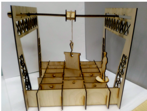
Рисунок 2. Макет Мостового крана для цеха электролиза меди, изготовленный из фанеры.
